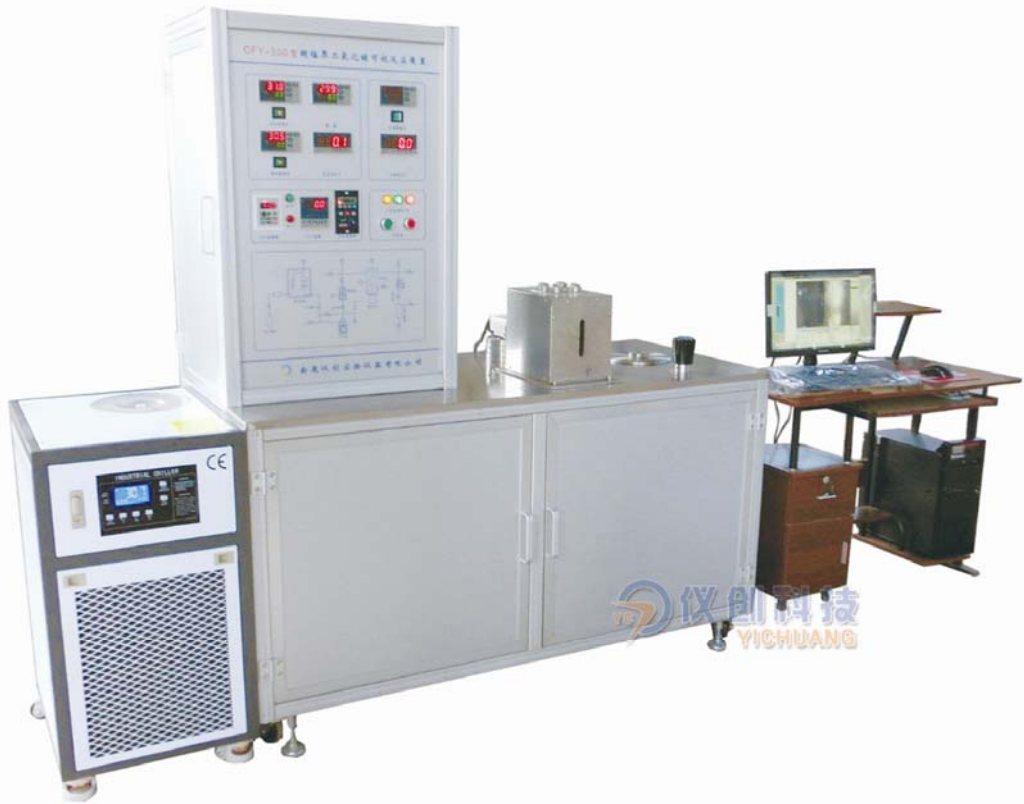
CFY-500 型超临界二氧化碳可视反应装置
